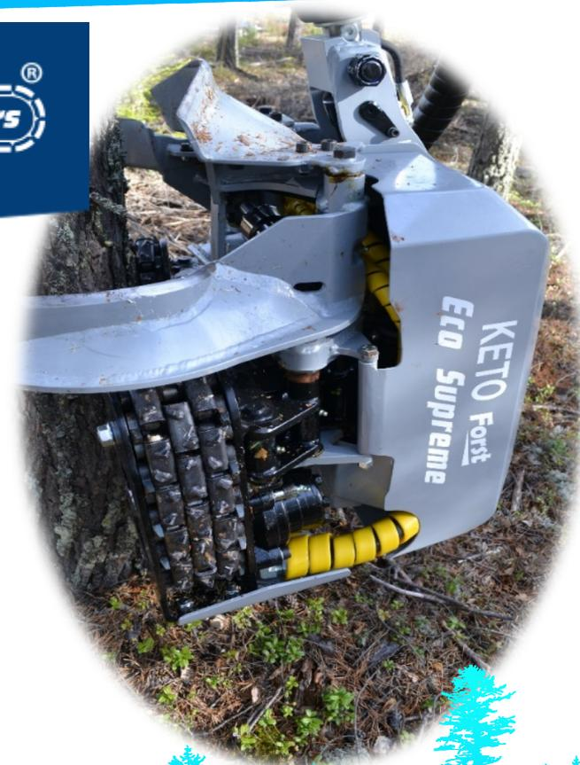
Шарнир подвески головки оснащен патентованной **системой блокировки** при установке головки в положение валки, что позволяет избежать раскачивания головки при подведении ее к дереву.
